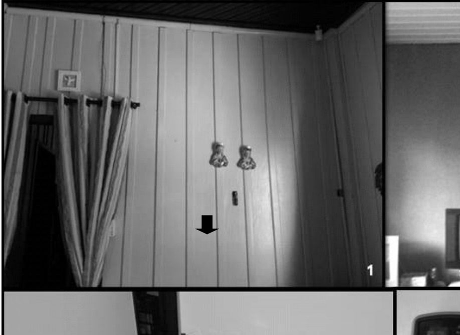
Figura 2 – Termo-higrômetros instalados nas residências.
