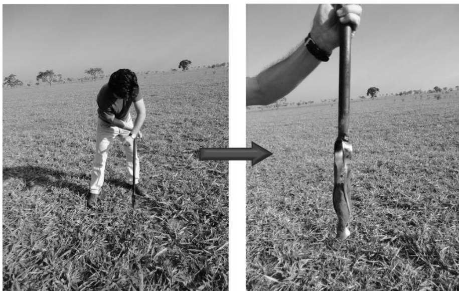
Figura 2: Coleta de amostra de solo com o trado do tipo holandês.
