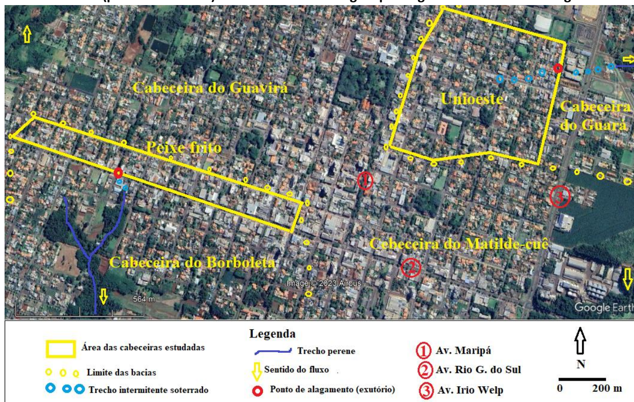
Figura 3: Áreas de contribuição nas cabeceiras urbanizadas dos córregos Guará (ponto Unioeste) e Borboleta (ponto Peixe frito). A área urbana abrangida pela figura 3 é destacada na figura 2.
