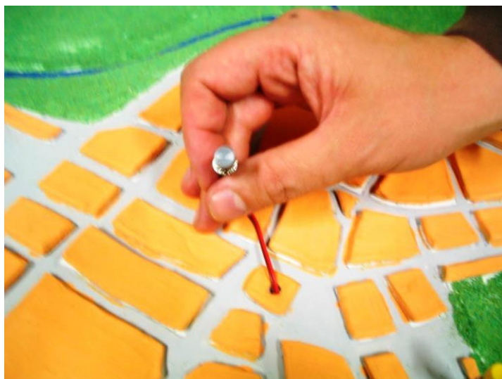
Figura 9: Sensor de toque instalado para inserção de sons programados na maquete tátil.
